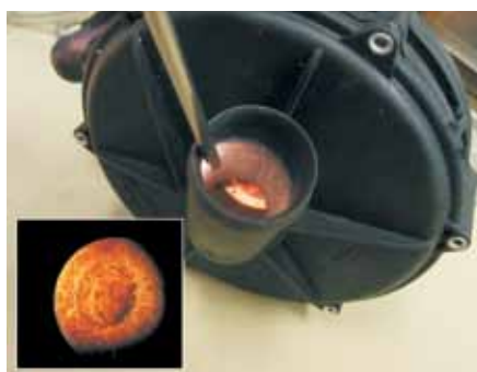
Zicht op de gecorrodeerde inlaat van een secundaireluchtpomp
