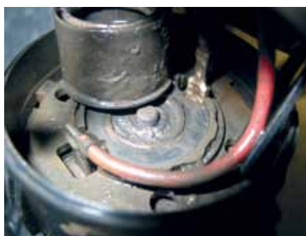
EGResief uitlaatgascondensaat in aandrijfmotor van een secundaireluchtpomp
