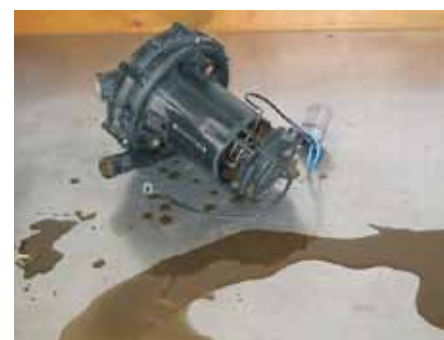
Vloeibaar uitlaatgascondensaat uit een secundaireluchtpomp
