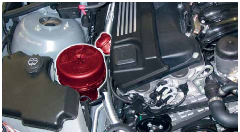
Secundairelucht klep en secundaireluchtpomp in de BMW E46 (geaccentueerd)
